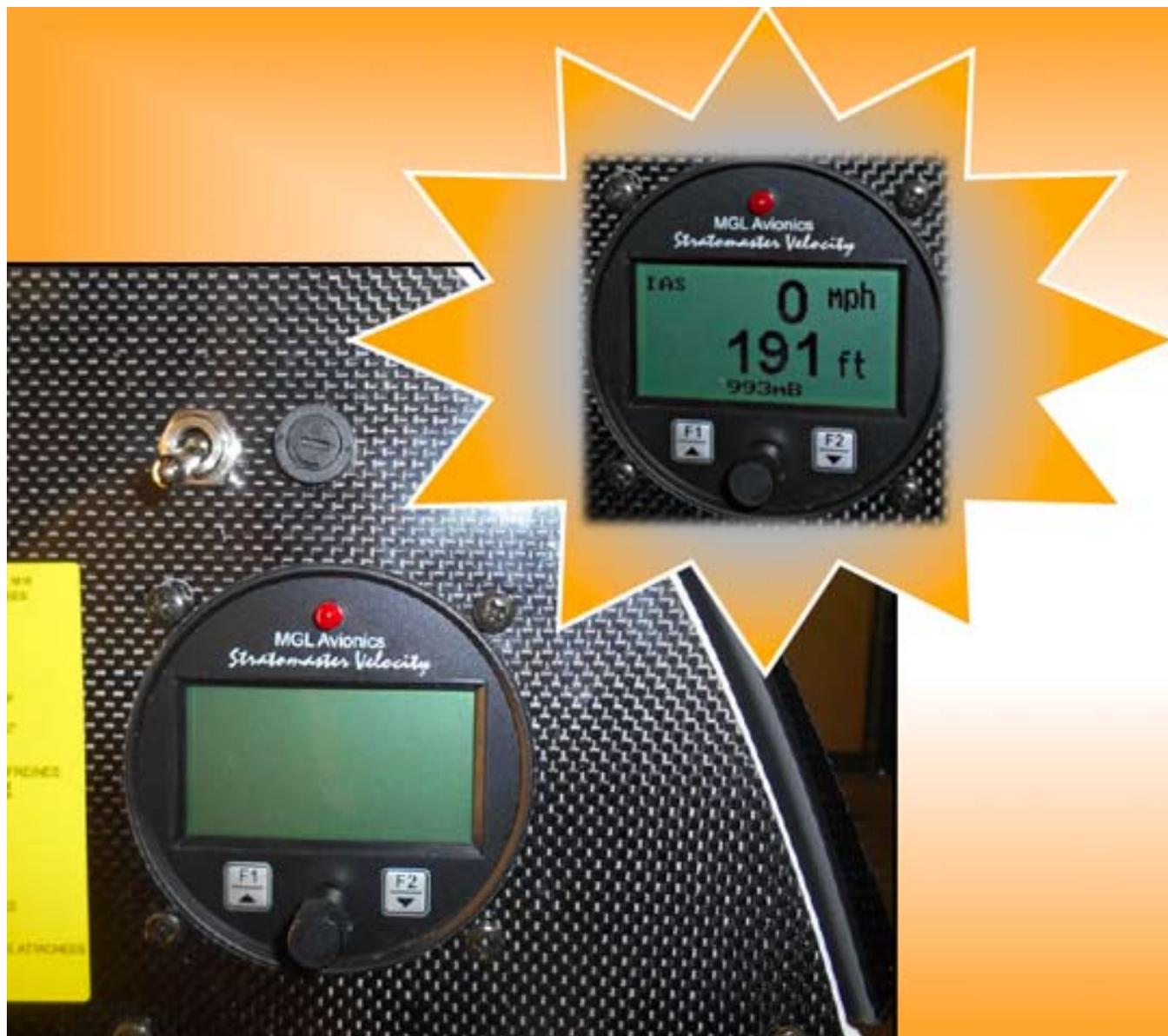
L'instrument digital ASX2 réalisé par MGL permet à l'instructeur une lecture aisée de l'ALT et de l'ASI.
